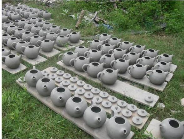
Una volta che il prodotto è ben essiccato viene cotto in forni a legna ad una temperatura fino a 600 gradi (il procedimento è chiamato BISCUIT FIRE).
